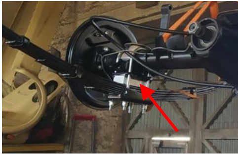
Une cale de rehausse du train arrière et installé pour compenser la transformation de pare-choc caoutchouc à chromé
