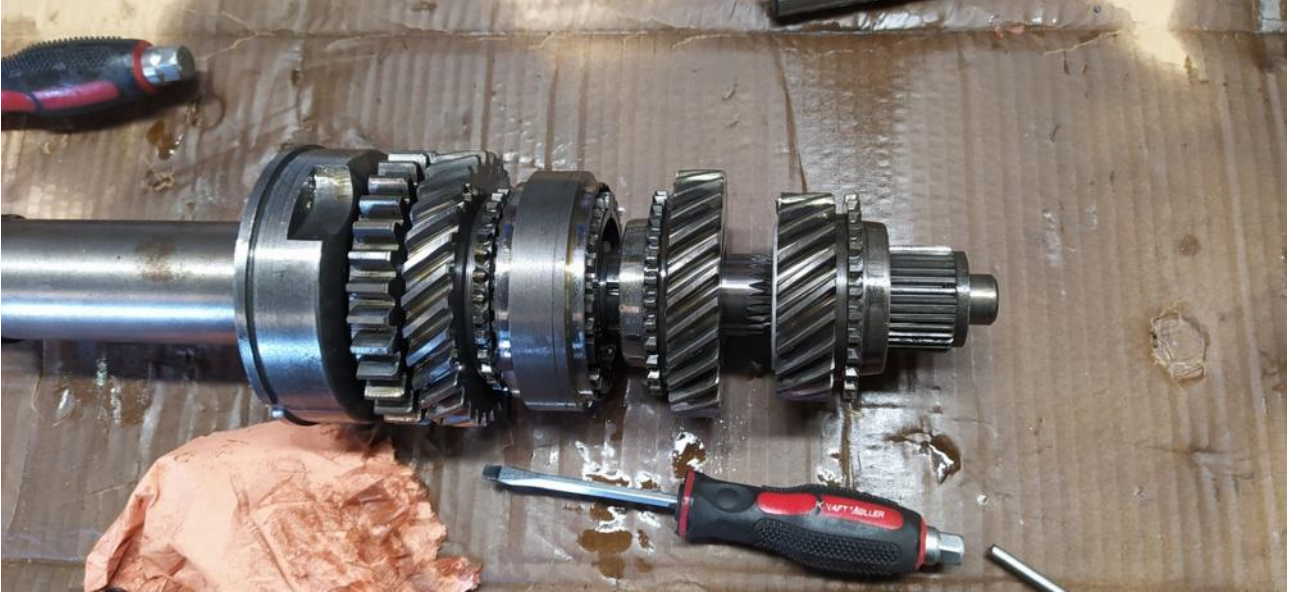
Les quatre bagues de synchro de l'arbre de sortie sont changé par des pièces neuves ;
