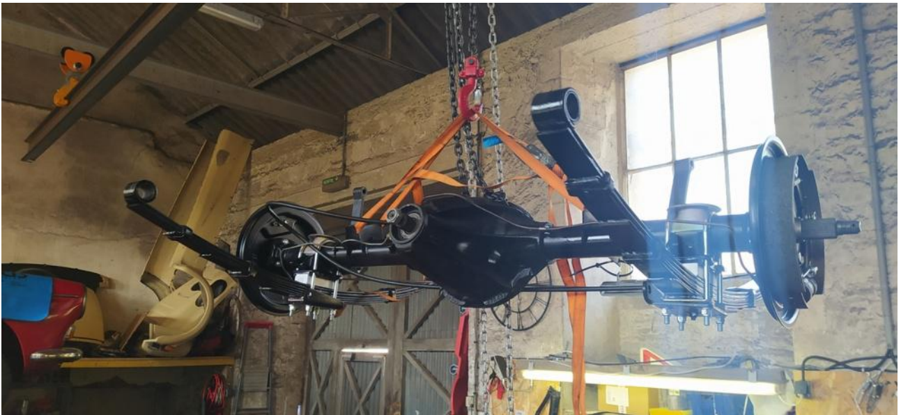
Une cale de rehausse du train arrière et installé pour compenser la transformation de pare-choc caoutchouc à chromé
