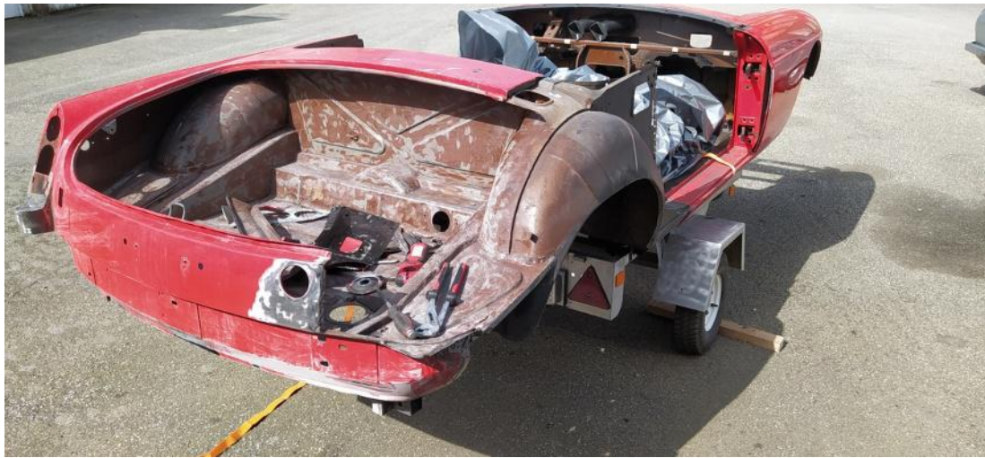
La partie intérieure de l'aile est traitée à la peinture galvanisée pour une protection contre la rouille.
